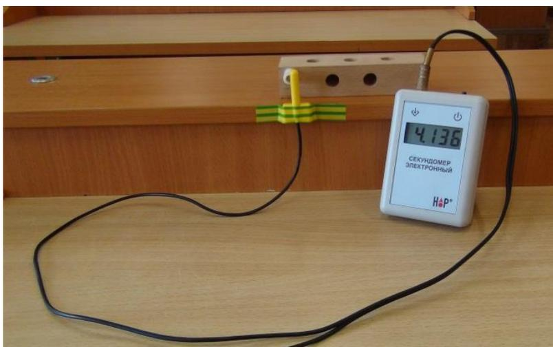
*С помощью скотча к торцу стола ребята прикрепляют герконовый датчик, затем по столу приближают к нему брусок со вставленным магнитом и наблюдают срабатывание датчика, фиксируют расстояние, на котором это срабатывание происходит, экспериментируют и делают выводы.*
